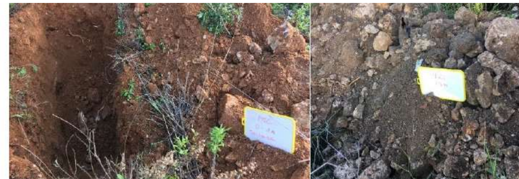
Prélèvements de matériaux pour essais laboratoire
